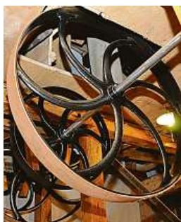
Všechny stroje v mlýně jsou poháněny přes transmisí.
