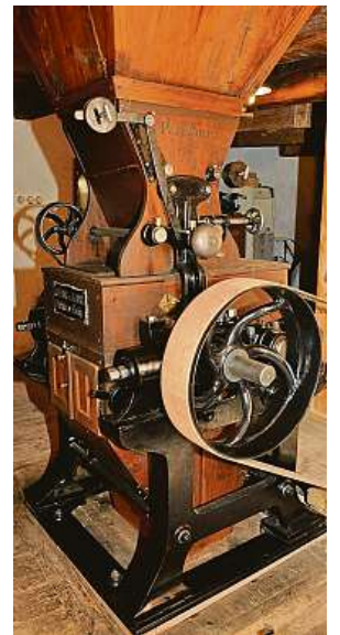
Očištěné a obroušené zrno se mele na válcové mlecí stolici.
