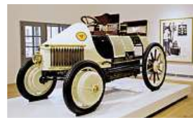
Pokrokový vůz Lohner-Porsche Semper Vivus (1900) neměl dojezd omezen kapacitou akumulátorů. Dobýjely je totiž dva benzinové jednoválce.
