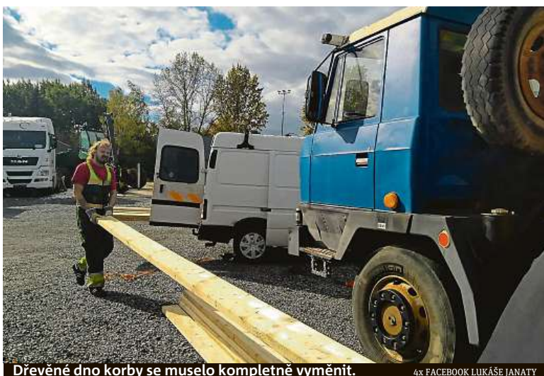
Dřevěné dno korby se muselo úplně vyměnit.
