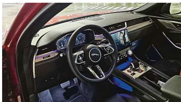
Obrazovka infotainmentu už není vnořená do palubky, ale je jaksí vystouplá. Pohání ji operační systém Pivi Pro.
