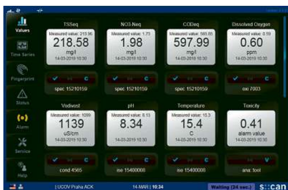
Měření kvality odpadních vod pomocí sondy S::CAN v ÚČOV Praha.
