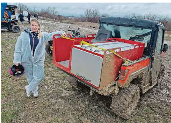
Korba s nosností téměř půl tuny umožňuje zajímavé zástavby. Hasičský speciál dostal nádrž na vodu, box a koleje na nosítka. METRO
