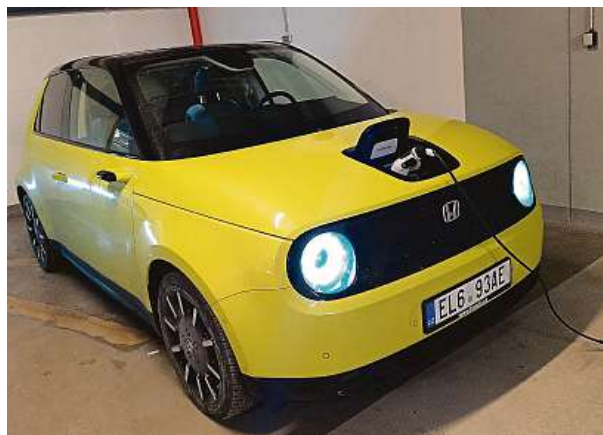
Z přípojky AC 6,6 kW typu 2 dobijete auto za čtyři hodiny.
