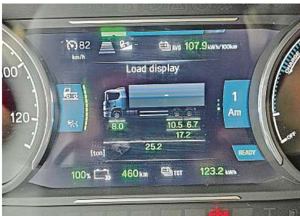
Displej zobrazuje zatížení náprav, dojezd i spotřebu.
