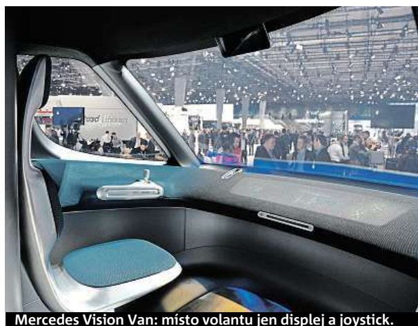
Mercedes Vision Van: místo volantu jen displej a joystick.
