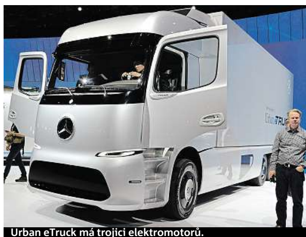
Urban eTruck má trojici elektromotorů.
