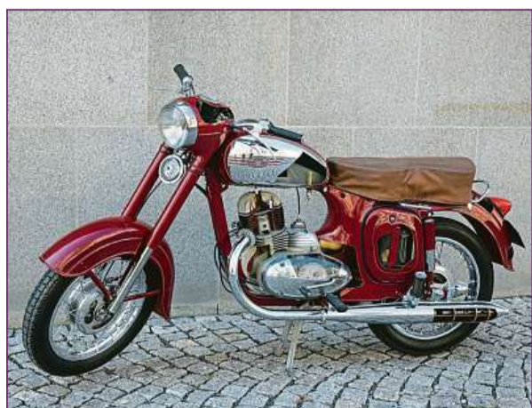
Motocykl Jawa-ČZ 250 typ 353 v řezu Závody 9. května, n. p. Praha 1954-1962 (v sériové výrobě)
