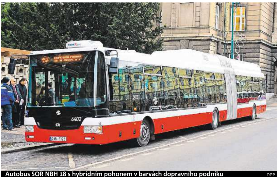
Autobus SOR NBH 18 s hybridním pohonem v barvách dopravního podniku DPP
