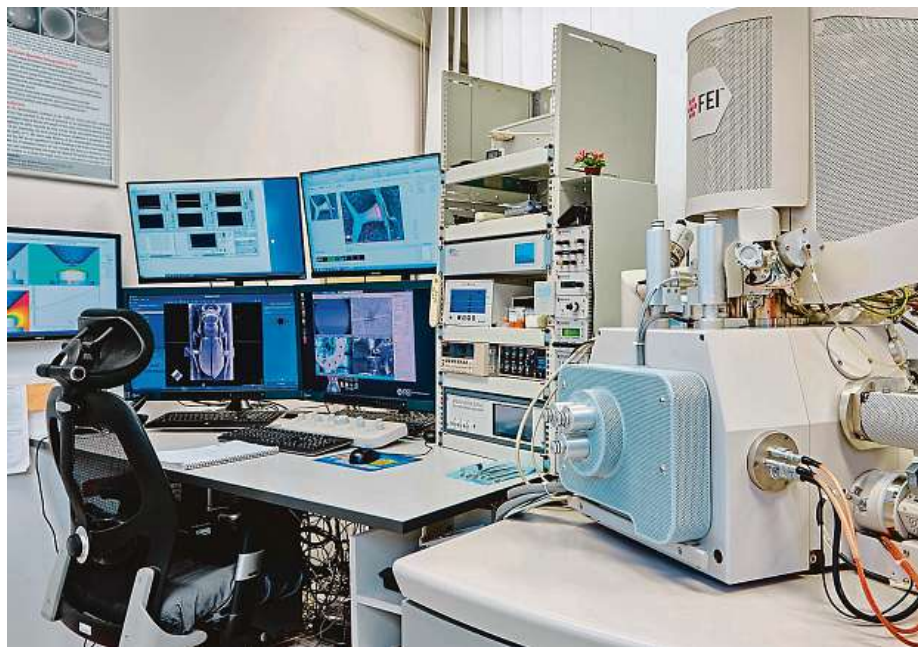
Prototyp unikátního elektronového mikroskopu pro realizaci metody A-ESEM
