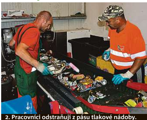
2. Pracovníci odstraňují z pásu tlakové nádoby.
