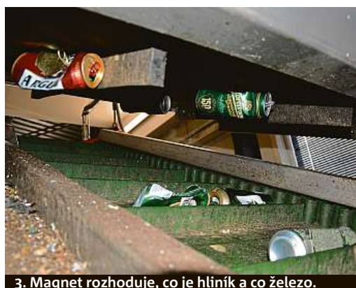
3. Magnet rozhoduje, co je hliník a co železo.
