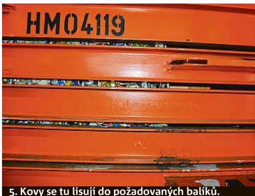
5. Kovy se tu lisují do požadovaných balíků.
