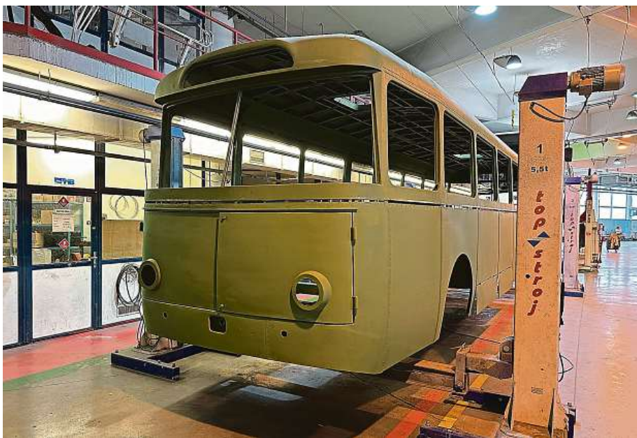
Pracovníci vozovny v Komině čekají tisíce hodin práce, aby trolejbusu 9Tr vrátili podobu z roku 1980. Doteď se u externí firmy opravoval skelet. DOPRAVNÍ PODNIK MĚSTA BRNA
