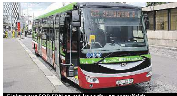
Elektrobus SOR EBN 11 má kapacitu 93 cestujících.
