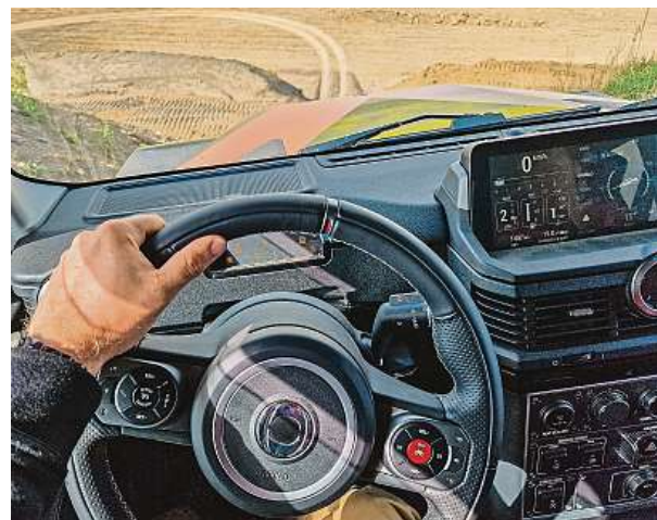
Před řidičem chybí klasické budíky, je zde jen malý obdélník, v němž se zobrazují pouze nejdůležitější provozní ikonky.
