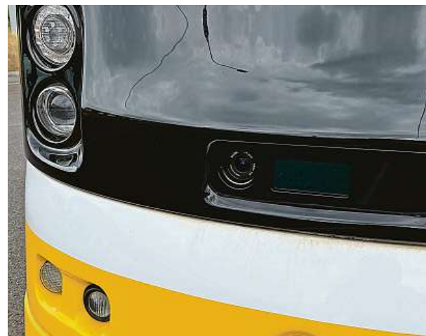
Škoda 40T byla dodatečně obohacena nejmodernější technikou. Klíčové jsou například kamery a senzory v přední části vozu.
