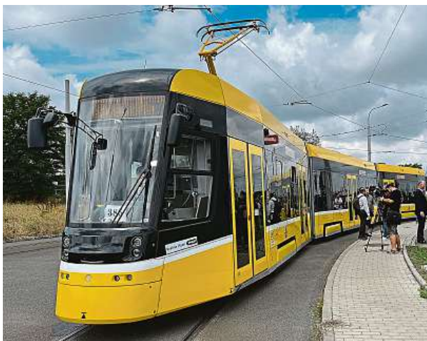
Škoda 40T byla dodatečně obohacena nejmodernější technikou. Klíčové jsou například kamery a senzory v přední části vozu.
