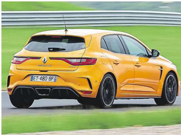
Zadku auta vévodí členitý difuzor pro zvyšování přítlaku.
