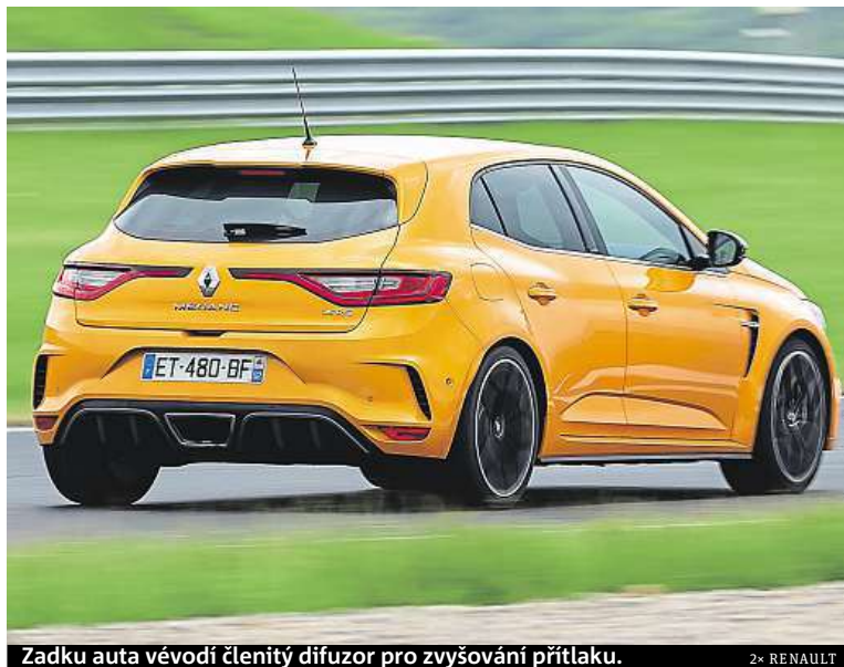
Zadku auta vévodí členitý difuzor pro zvyšování přítlaku.
