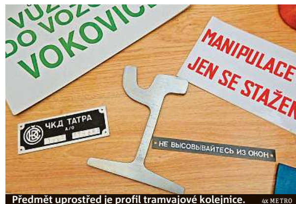
Předmět uprostřed je profil tramvajové kolejnice.
