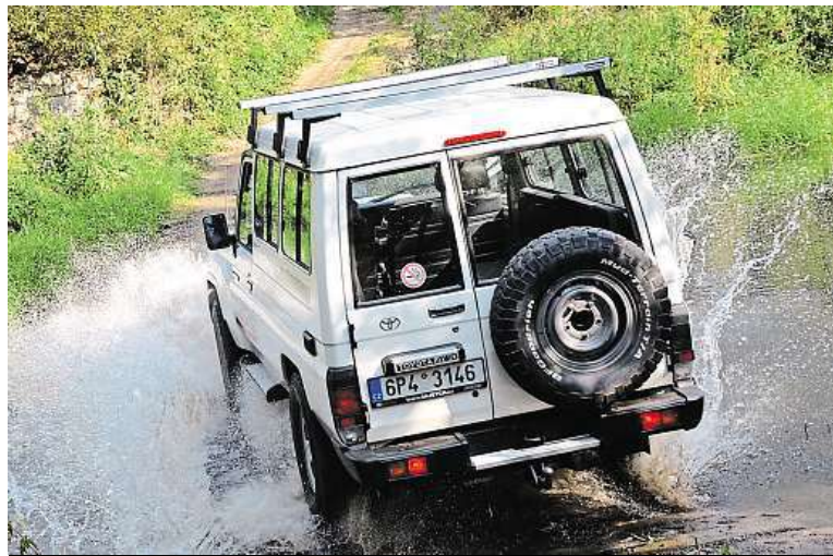
Standardní provedení přebrodí maximálně vodu hlubokou 75 cm.
