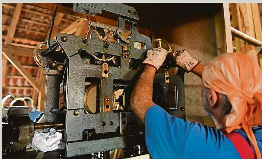
Kontrola věžních hodin. Díky ní nedochází ke zpoždování či předcházení času.
