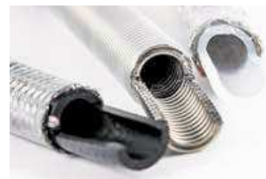
Rez vodovodními hadičkami, zleva: z pryže, z nerezové oceli (hadička Flexira), ze silikonu
