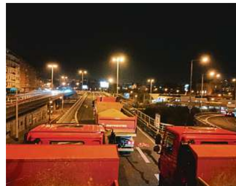
Zatěžovací zkoušky mostu X022 Bubenská u Vltavské 14. 12. 2018.
