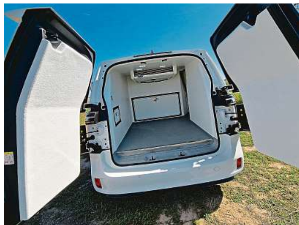
Hmotnost termoizolační vestavby je asi dvě stě kilo. To ovlivňuje dojezd vozu, stále se však pohybuje kolem 400 kilometrů. 2x METRO
