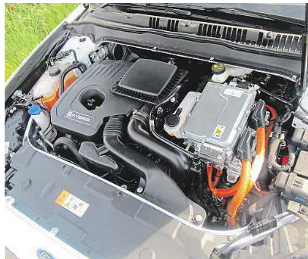
Elektromotor je vpravo, vlevo klasický benzín.
