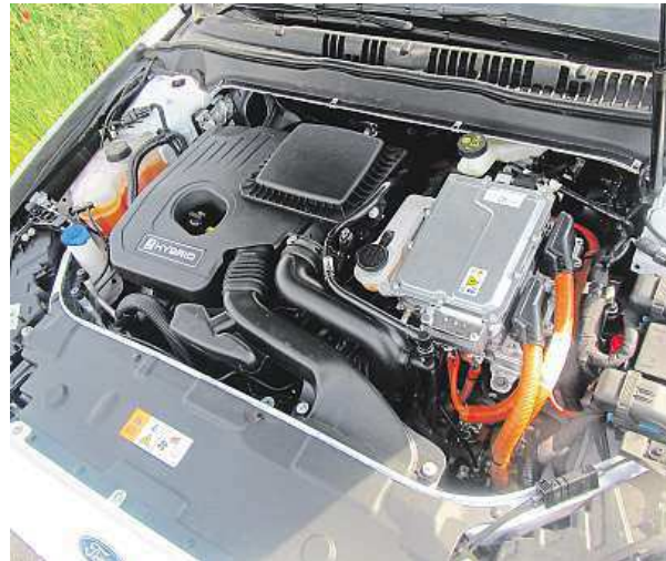
Elektromotor je vpravo, vlevo klasický benzín.
