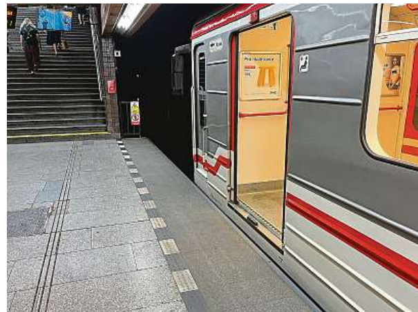
Překážkou pro vozíčkáře je mezera mezi hranou nástupiště a vagonem. Ta je nezbytná pro boční výkyvy vozů, daný jejich odpružením a zatížením. Proto začal před lety dopravní podnik do stanic instalovat rampy k prvnímu a gumové přechody k poslednímu vagonu.
