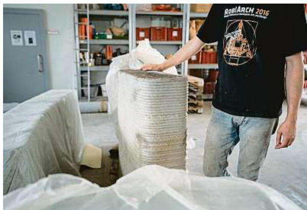
Překážky jsou vyplněny betonem z recyklátu. 2x VUT – JAN PROKOPIS
