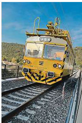
Nejprve se na most vydal motorový univerzální vozík, který mimo jiné kontroluje troleje, pak na scénu přijel stotřicetitunový Sergej (foto uprostřed) a po něm ještě o 50 tun těžší parní Šlechtična.
