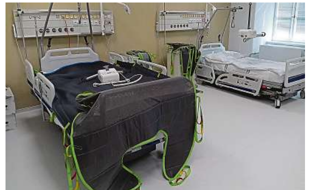
Vlevo lůžko s nosností 500 kilogramů s plachtou, do které lze zavést pacienta vážícího až 300 kilogramů. Vpravo lůžko na 200 kilogramů.
