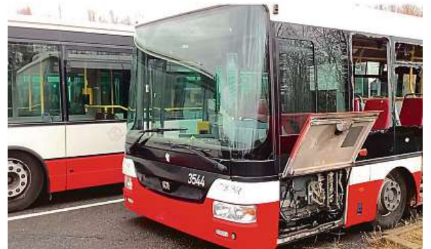
Autobus typ SOR NB12. Najeto má 829 517 kilometrů a jeho stav tomu odpovídá. Uniklý vzduch, provozní kapaliny, rezne rám. 5x DPP
