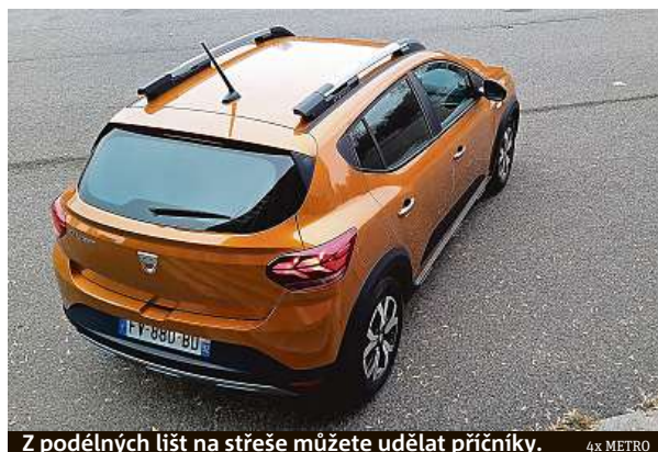
Z podélných lišt na střeše můžete udělat příčnicku. 4x METRO
