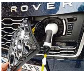
Zásuvka pro dobíjení je v přední masce, plně nabitě auto ujede čistě na elektrinu 49 kilometrů. Na závěr jízdy vyhodnotí počítač váš jízdni styl.
