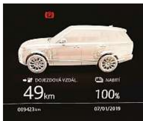
Zásuvka pro dobíjení je v přední masce, plně nabitě auto ujede čistě na elektrinu 49 kilometrů. Na závěr jízdy vyhodnotí počítač váš jízdni styl.
