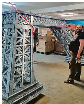
Takhle se v pražských Počernicích skládala 3D vtištěná kopie Eiffelovy věže.
