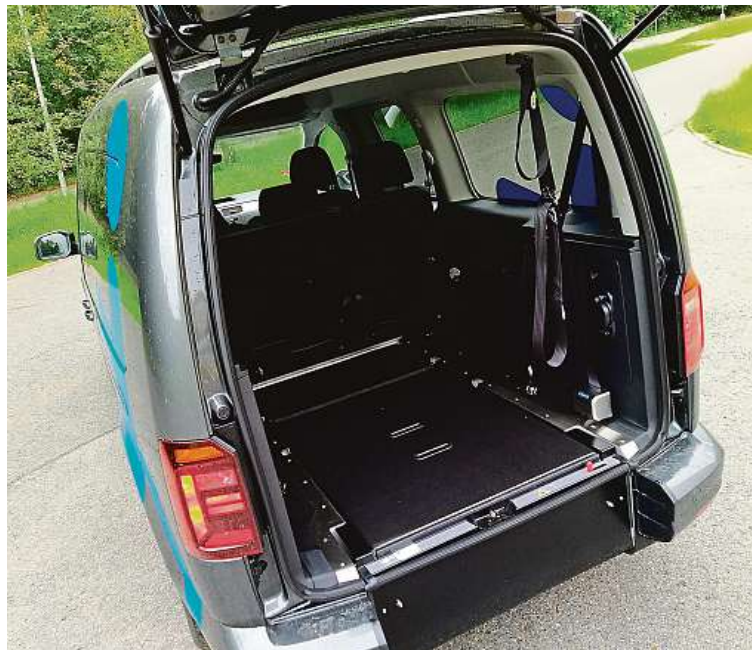
Vozík lze ukotvit pomocí pásů. Rampa je vynálezem české firmy.
