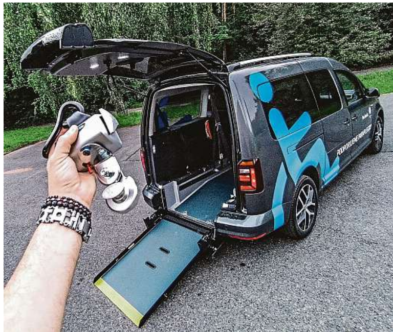
Samonavíjecí pás a vytažená nájezdová rampa. Ta má příjemně malý sklon.
