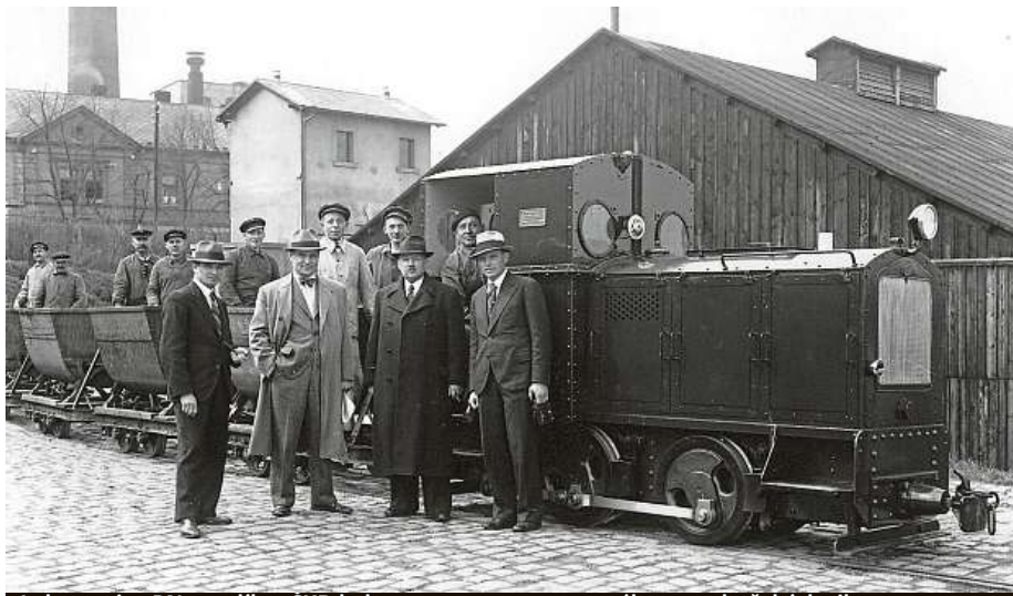
Lokomotiva BN27 z dílen CKD byla osazena motorem o výkonu 27 koňských sil.
