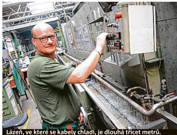
Lázeň, ve které se kabely chladí, je dlouhá třicet metrů.
