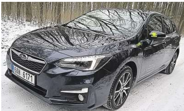
BiLED přední světlomety se automaticky natáčejí v zatáčce.
