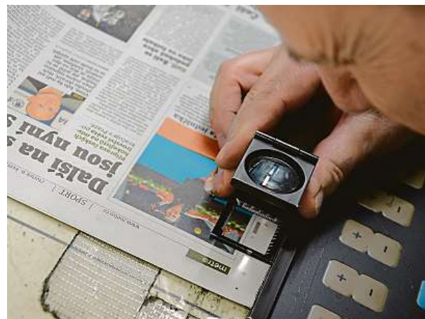
Tiskař kontroluje pasovací křížek.
