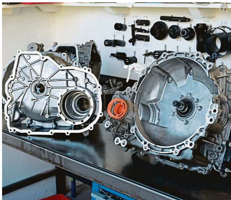
Převodovka 8F35/40/57 je sice spolehlivá, ale potřebuje pravidelné výměny oleje, což její majitelé často nedělají. A tak se bohužel odporoučí.
