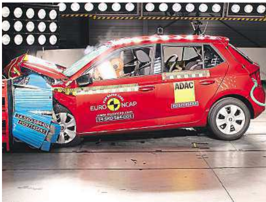
Čelní náraz fabie do deformovatelné překážky v rychlosti 64 km/h a jeho následky.
