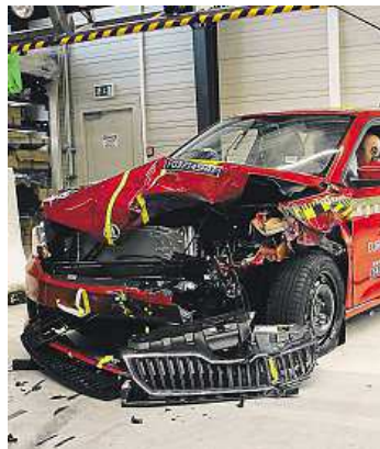
Čelní náraz fabie do deformovatelné překážky v rychlosti 64 km/h a jeho následky.
