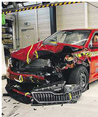
Celní náraz fabie do deformovatelné překážky v rychlosti 64 km/h a jeho následky.
