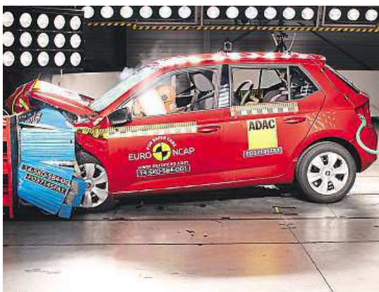
Celní náraz fabie do deformovatelné překážky v rychlosti 64 km/h a jeho následky.
