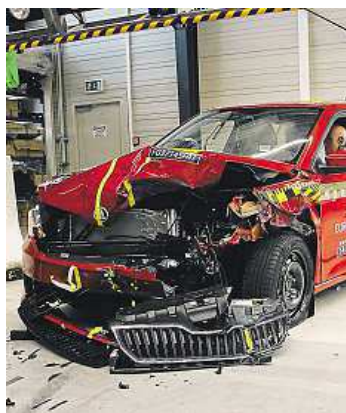
Celní náraz fabie do deformovatelné překážky v rychlosti 64 km/h a jeho následky.
