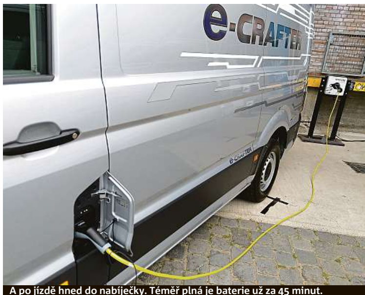
A po jízdě hned do nabíječky. Téměř plná je baterie už za 45 minut.
