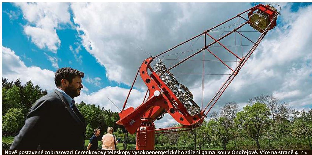
Nově postavené zobrazovací Čerenkovovy teleskopy vysokoenergetického záření gama jsou v Ondřejově. Více na straně 4 ČTK
