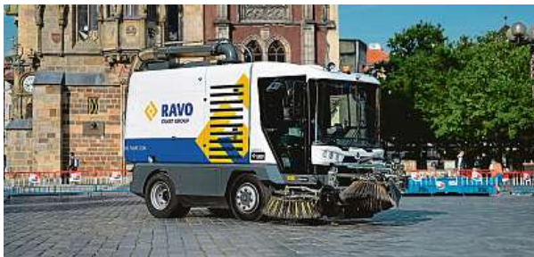
Vůz RAVO 5 eSeries jezdí rychlostí až 40 km/h. Ideální je pro rychlé čištění nádob, mobiliáře, vysávání listí a vyprazdňování košů. PS
